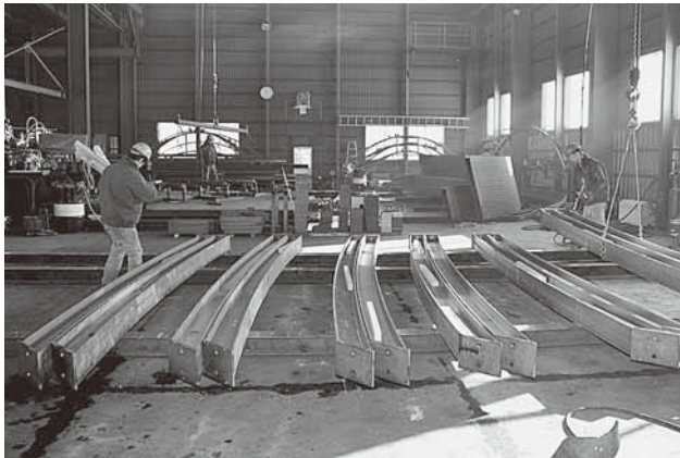
船本工業芦別工場の内部。トンネル工事に欠かせない鉄骨部品などが次々に出来上がる
