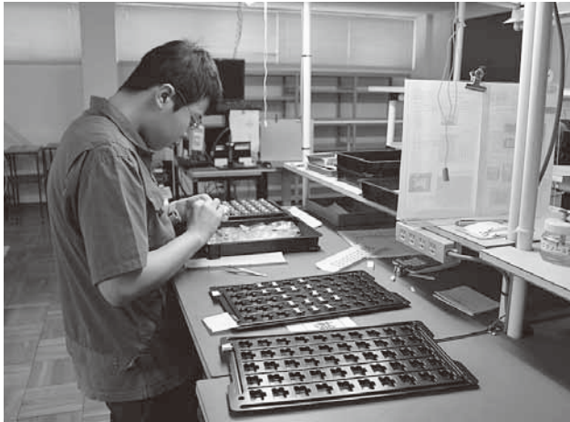
バーコードスキャナの心臓部にあたる「モジュールエンジン」の検品の様子
